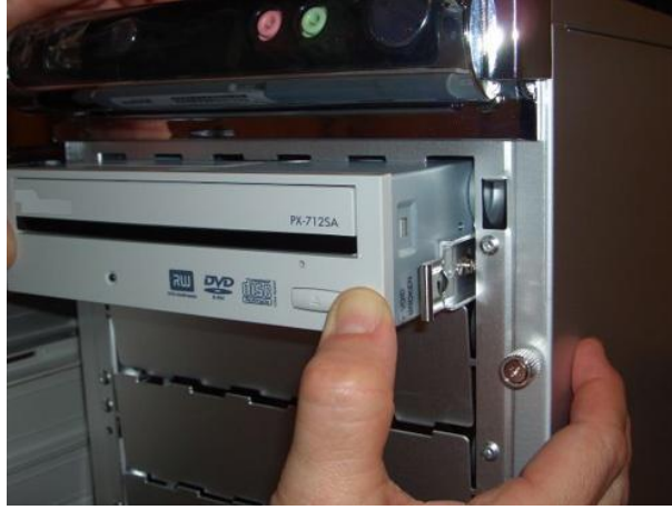
Resim 2.7: Optik sürücü montajı
