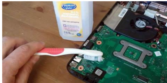
Resim 4.15: Donanım birimlerinin temizlenmesi
