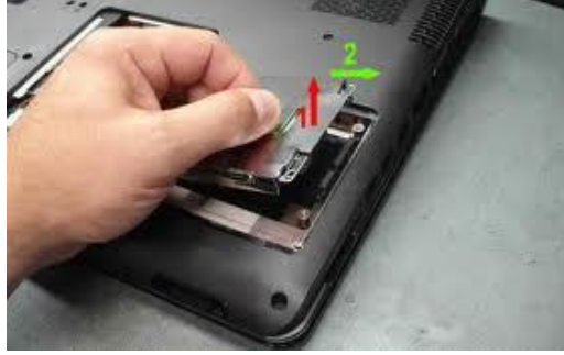
Resim 4.7: Dizüstü bilgisayarda hard-disk'in sökülmesi
