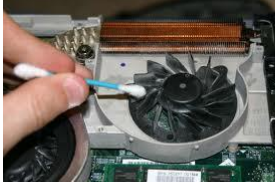
Resim 4.5: Dizüstü bilgisayar fanının temizlenmesi
