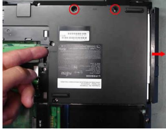
Resim 4.9: Dizüstü optik okuyucusunun sökülmesi
