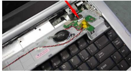
Resim 4.12: Klavye balantı kablolarının sökülmesi
