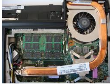
Resim 4.4: Dizüstü bilgisayar işlemci ve soğutucu fanı
