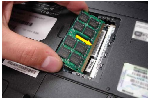
Resim 4.6: Dizüstü bilgisayarda RAM'in değiştirilmesi
