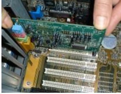
Resim 2.8: Ses kartının kontrol edilmesi
