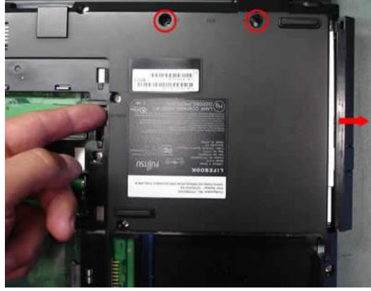
Resim 4.9: Dizüstü optik okuyucusunun sökülmesi
