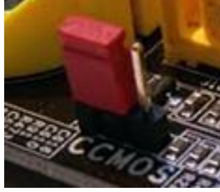
Resim 2.1: BIOS sıfırlama jumper'ı
