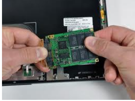
Resim 4.10: Dizüstü bilgisayar ekran kartının değiştirilmesi
